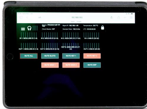
**Remote** Die Bedienung kann in gleicher Weise wie am Gerät auch über einen Browser an einem beliebigen Gerät erfolgen
