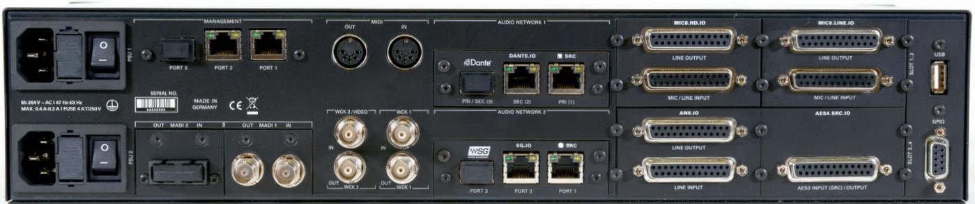
**Prodigy MP Mainframe** Doppelnetzteil, zwei MADI Interfaces, drei Ethernet-Ports, MIDI -und Clock-Anschlüsse, analoge und AES3-IO-Karten mit D-Sub25-Anschlüssen sowie Netzwerk-I/Os für Dante und SoundGrid
